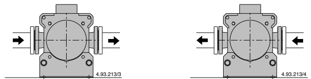
Вариант 1: всасывание слева, подача справа
